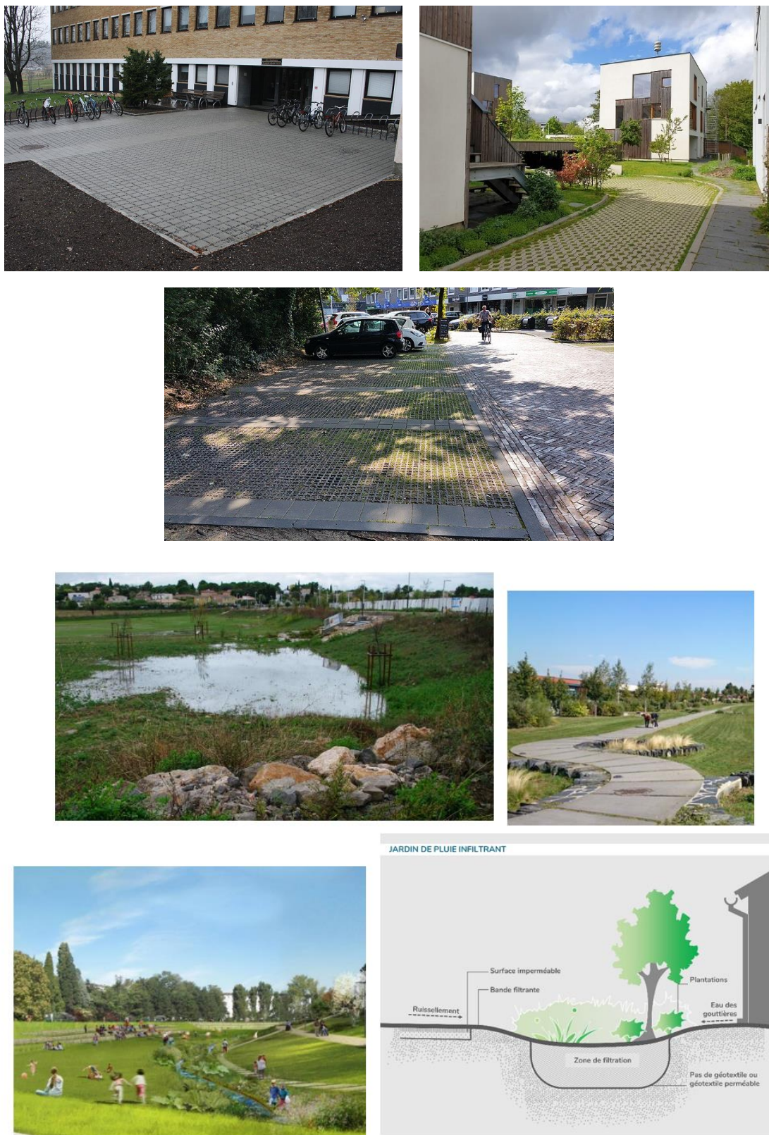
Figure 8. Exemple d'utilisation de matériaux drainants et perméables (sources : Alexander Henriksen /Nanda Sluijsmans)
